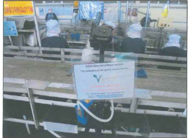
ภาพที่ 4 การเก็บตัวอย่างฝุ่นละอองรวม บริเวณรับวัตถุดิบ
