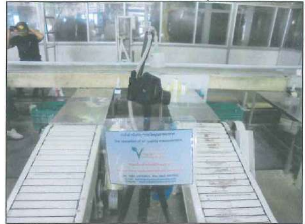
ภาพที่ 2 การเก็บตัวอย่างฝุ่นละอองรวม บริเวณเปลือกสับปรดอัด
