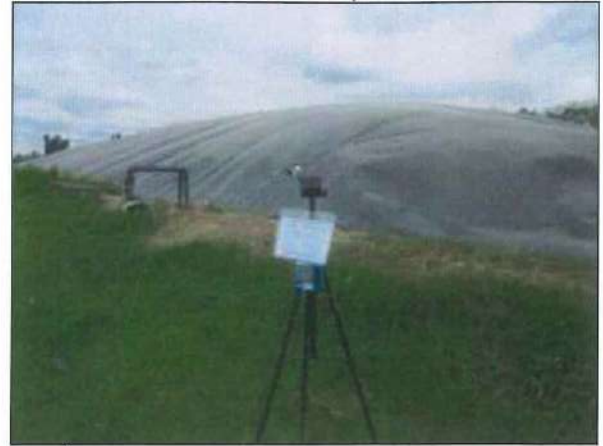
ภาพที่ 8 การเก็บตัวอย่างไฮโดรเจน ซัลไฟด์ บริเวณบ่อบำบัดน้ำเสีย บ่อ A
