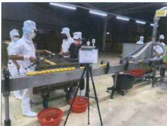
ภาพที่ 17 การตรวจวัดระดับความร้อน บริเวณไลน์เป่าลม
