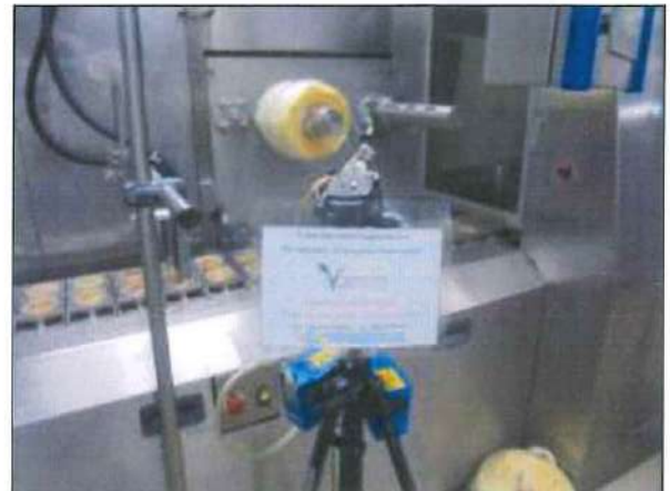
ภาพที่ 10 การเก็บตัวอย่างอะซิโตน และ เมแททิล เอทิล คีโตน บริเวณ Tiger (Mahout Inh TH-18 Hitachi)
